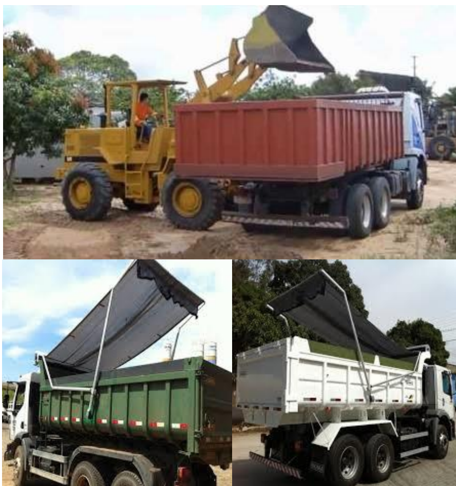
Figura 38. Caminhão basculante com tela de proteção.
