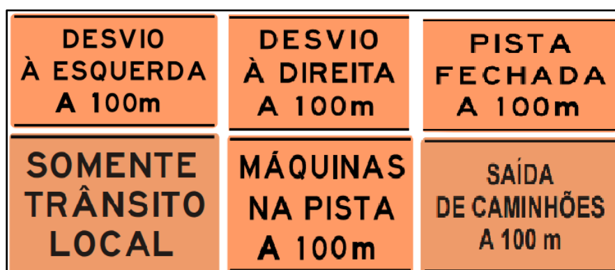
Figura 54. Exemplo de sinalização de advertência em obras.
