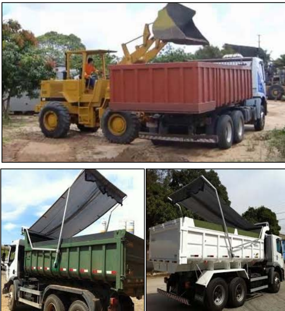
Figura 33. Caminhão basculante com tela de proteção.
