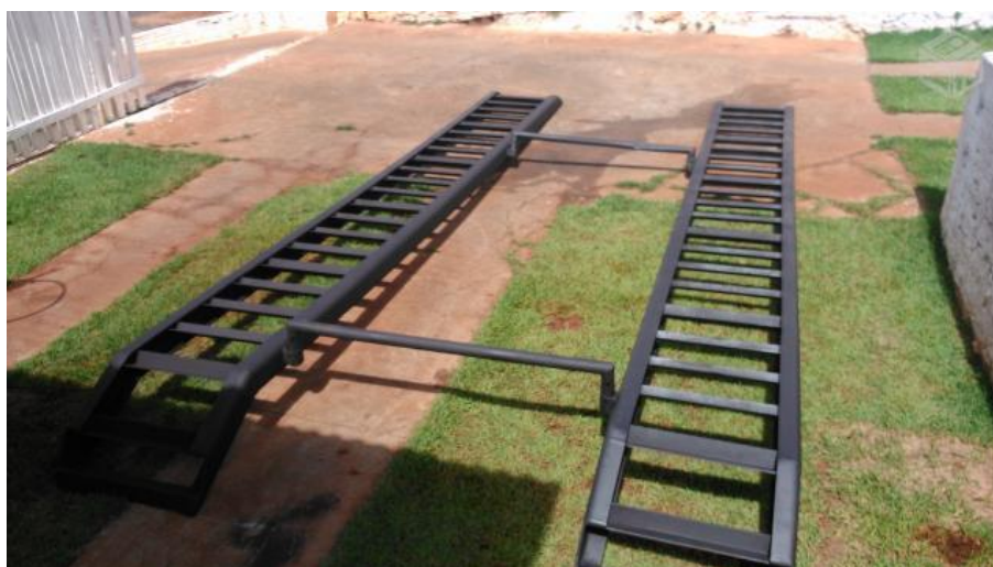
Figura 9. Rampa inclinada móvel.
