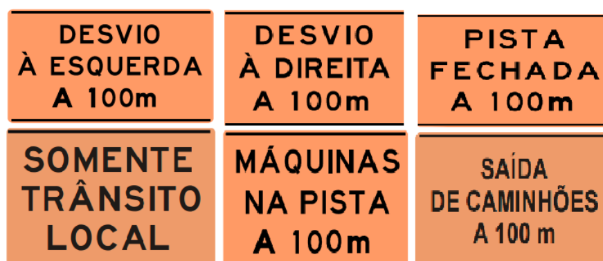
Figura 30. Exemplo de sinalização de advertência em obras.
