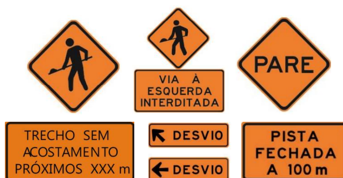
Figura 28. Exemplo de sinalização de advertência em obras.
