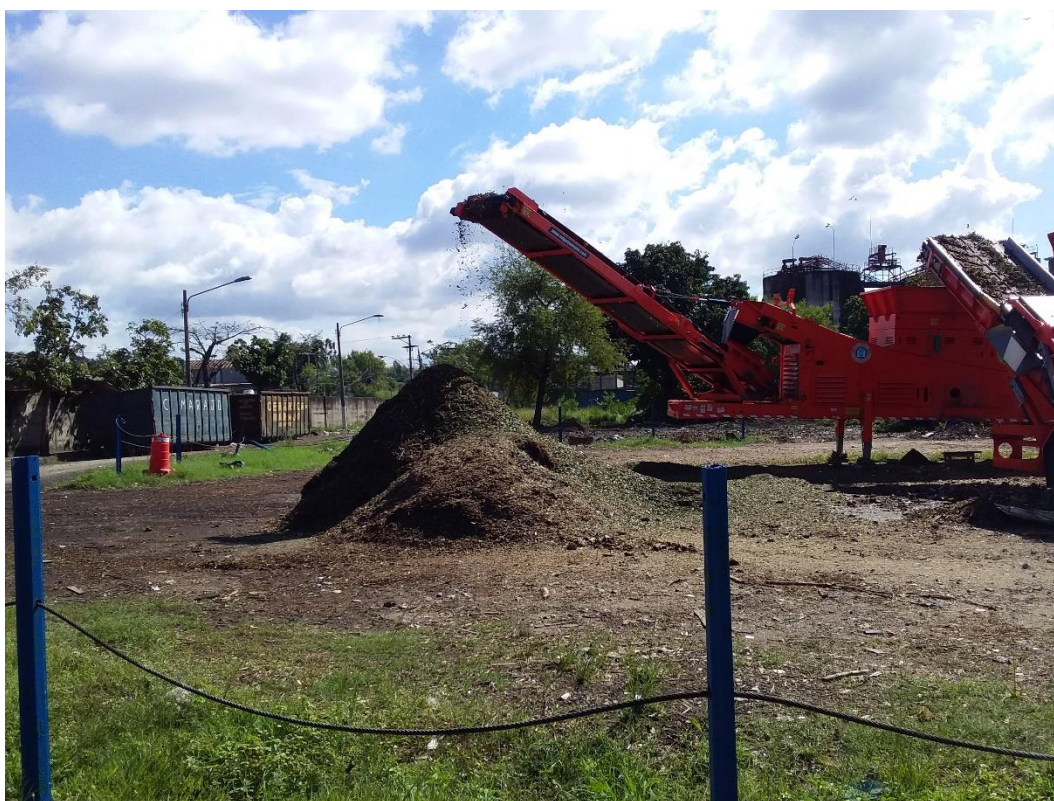
Figura 21 - Pátio de Leiras para Compostagem Aeróbia - COMLURB - RJ
