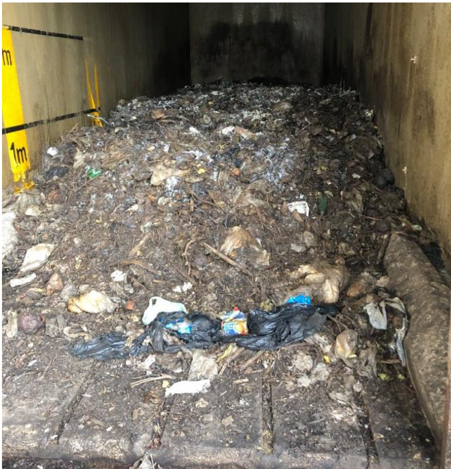
Figura 20 – Interior do Biodigestor com resíduos em processo de tratamento – COMLURB - RJ
