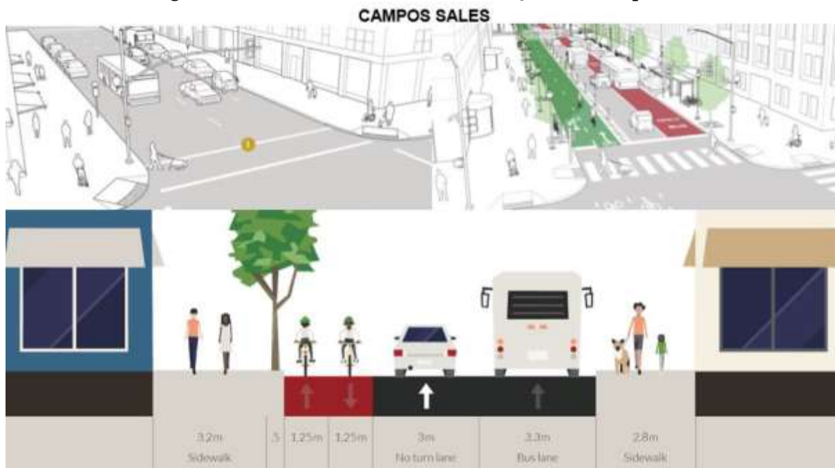
Figura 1.1.3.1 – TIPOLOGIA 03 - Intervenção AV. Campos Sales
