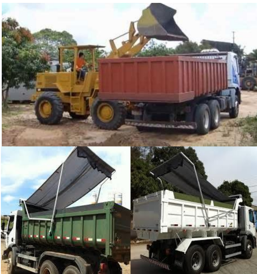
Figura 26. Caminhão basculante com tela de proteção.
