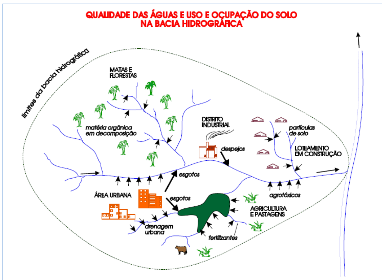
Figura 11.1. Representação esquemática de poluição pontual, representada pelas setas maiores, e difusa, representada pelas setas menores (Fonte: VON SPERLING, 2005).
