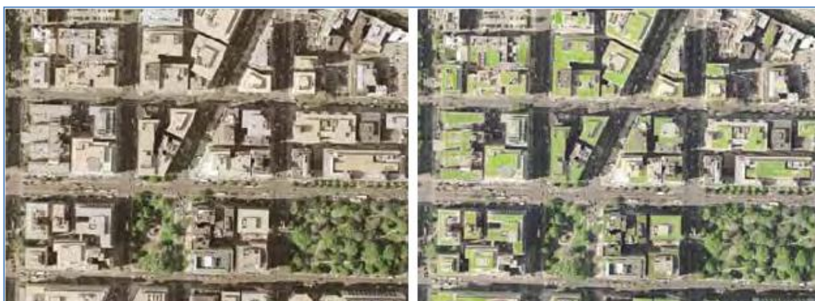
Figura 15.6. Washington, D.C. (EUA) pré(2002) e pós (2025): implementação de programa de instalação de telhados verdes em 20% das edificações (mais de 900 m 2 ).Crédito: Casey Trees Endowment Fund.
